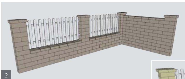
2 Vedere transversală asupra gardului executat din elemente Castello cu stâlpi de 40 x 20 cm
