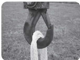
Montajul corzilor în cârligul macaralei
